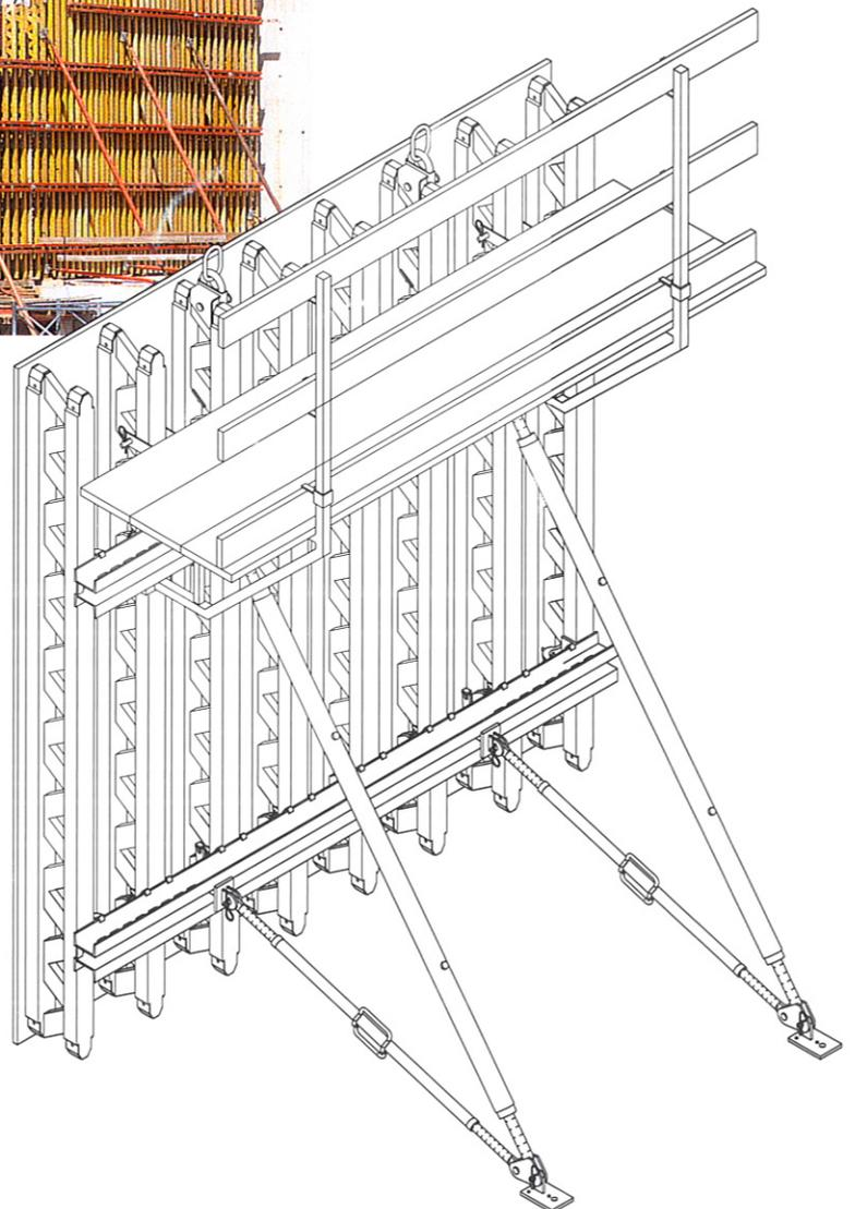
**I moduli VARIO si sovrappongono tramite il connettore 24.**
