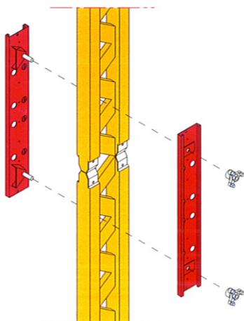
Il connettore 24 viene montato attraverso la struttura reticolare della trave GT 24, che non deve essere forata.
